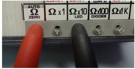
Ogni volta che si cambia la portata dell'ohmmetro ripetere le operazioni per la messa a zero dell'indice ruotando la manopola centrale.
