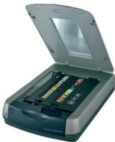
Lo **scanner** è un dispositivo esterno al computer che permette di acquisire in formato digitale fotografie, disegni e testi sotto forma di file immagine. Possiamo associare l'uso dello scanner a quello di programmi di riconoscimento dei caratteri, (detti OCR, Optical Character Recognition) o di elaborazione delle immagini.
