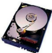
il **disco rigido** o **hard disk**, in cui vengono memorizzati in maniera permanente tutti i dati (dal sistema operativo, ai programmi, ai dati elaborati dall'utente). E' per dimensione il più importante esempio di memoria secondaria; la capacità di un disco rigido, infatti, è molto elevata e arriva
