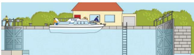
Durante la discesa del battello una persona per ogni cima terrà il battello accostato al muro della chiusa. Se siete solo in due sul battello, la cima posteriore può essere mantenuta dal guardiano della chiusa.
